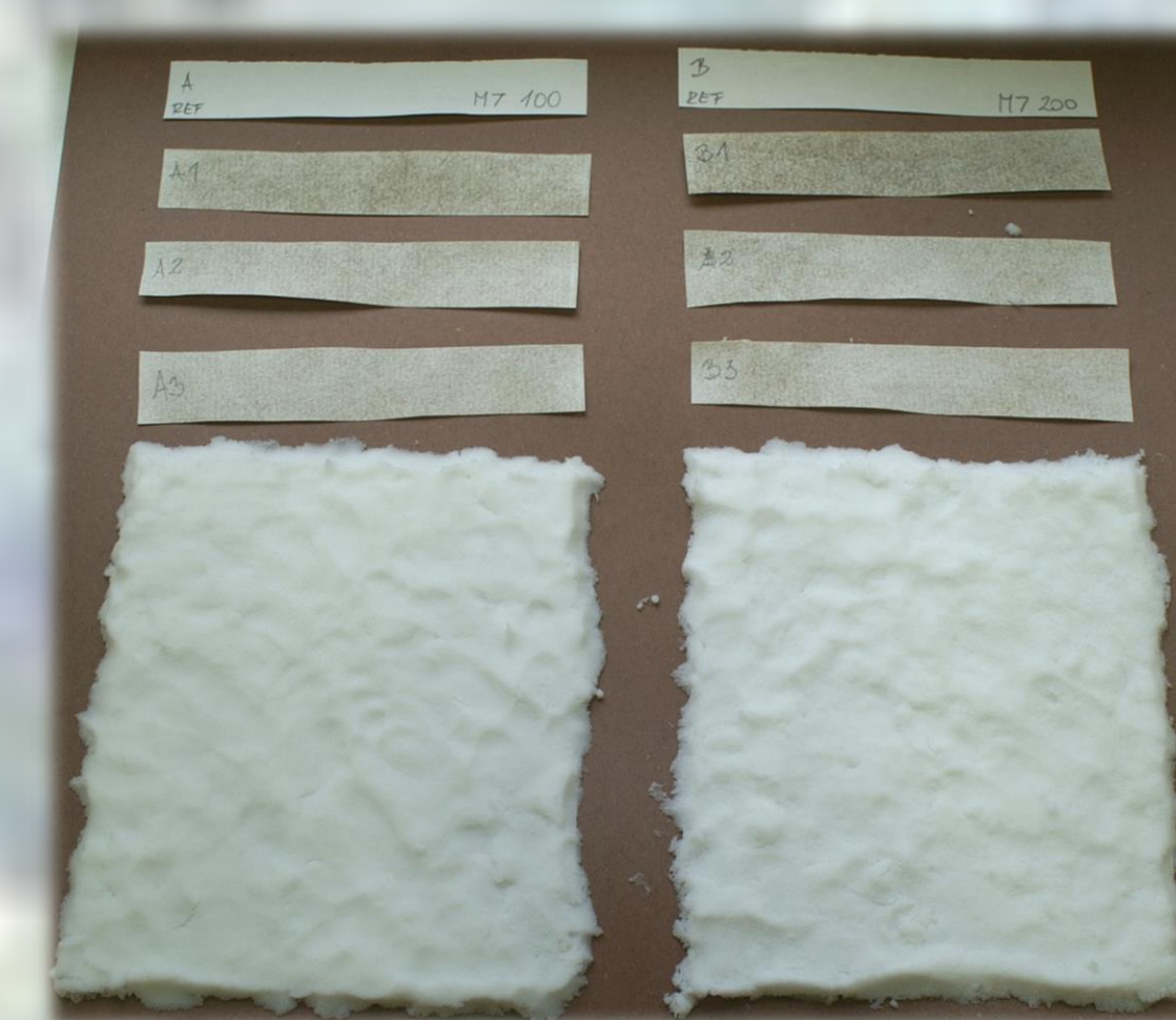
Opakování kroků samovolného čištění pomocí PERLOZY na vzorcích s reálným prachem
