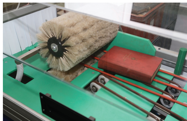
Obr. 2: Mechanické čištění knihy v systému kartáčů.
