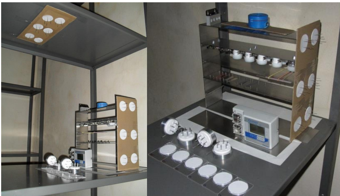
Obr. 1: Příklad umístění pasivních vzorkovačů depozice prachových částic v depozitáři Jihočeské vědecké knihovny na Zlaté Koruně
