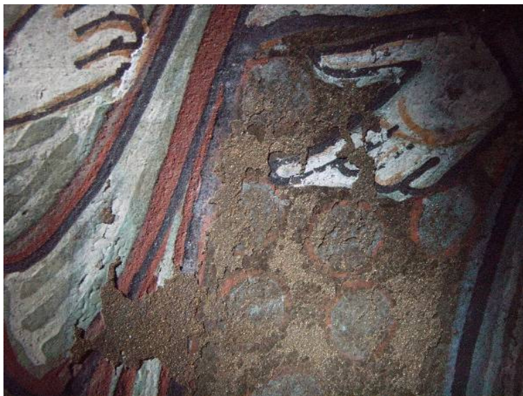
Detail 2, fol. 41v zvětšení 6,3x, detail úbytků barevné vrstvy a šupinatění barevné vrstvy.
