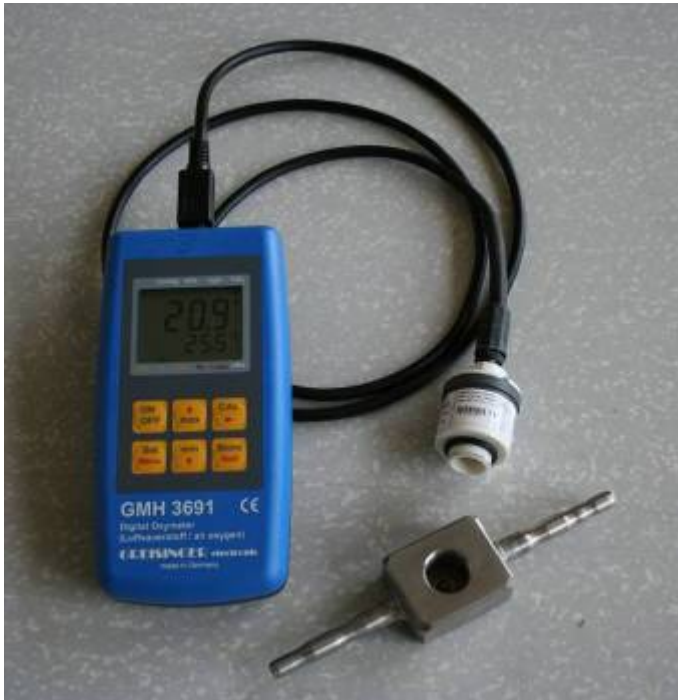
Obrázek 7. Oximetr s kyslíkovým čidlem a průtočným adaptérem.
