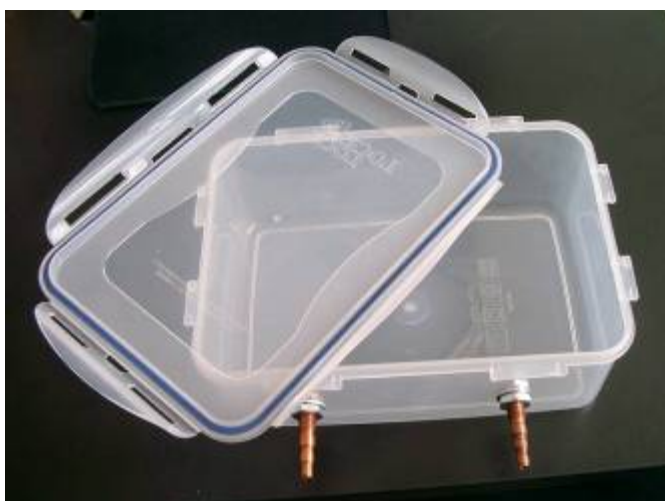
Obrázek 4. Box s víkem o objemu 2,6 litru (otevřený a uzavřený) opatřený průchodkami.
