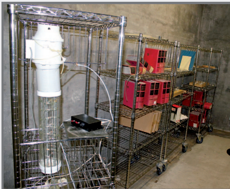
Generátor par složek esenciálních olejů s nucenou cirkulací kapalně fáze v modelovém depozitáři NK. Foto: Jana Dřevíková
